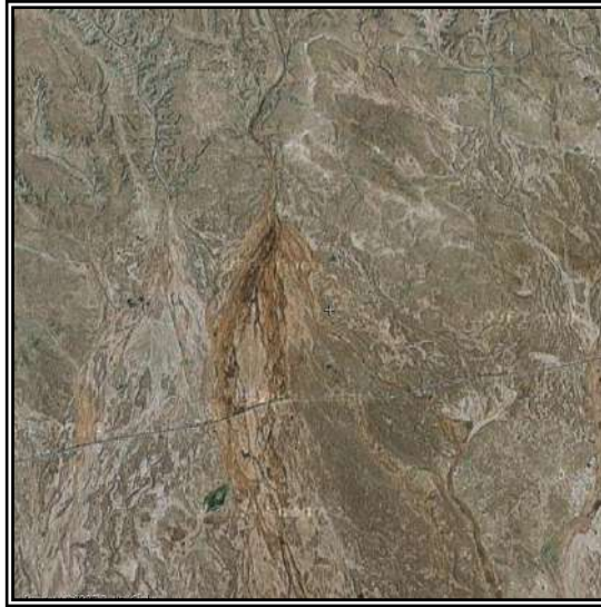
صورة (5): فضائية في حوض الإرساب تبين كيفية تفرع وادي تناملو عند دخوله منطقة السروال عند أسفل السفح الجنوبي للجبل الأخضر. لاحظ كيفية توجيه سرير فرعي الوادي نحو العبارتين المنشأتين تحت طريق المخيلي- الخروبة منذ إنشائهما.
