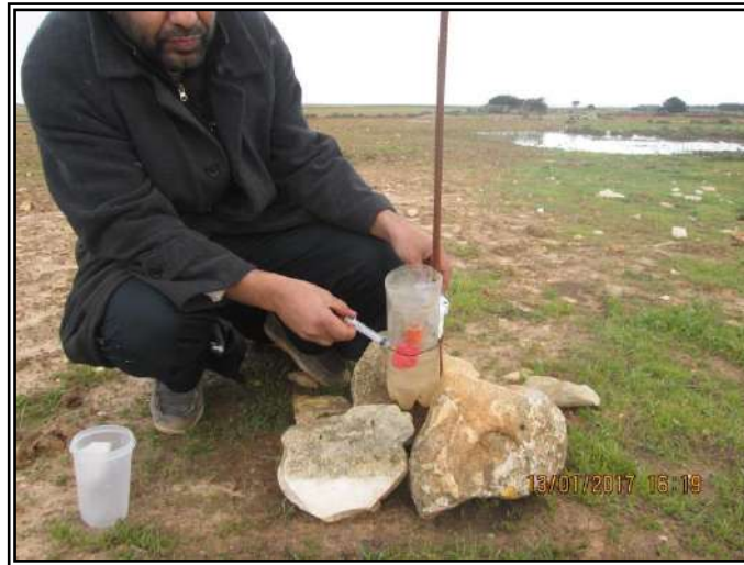
صورة (75): لاحظ ارتفاع المياه في مقياس المطر، ارتفاع المطر الساقط من المنخفض الجوي الثاني، محسوب من تقسيم حجم المياه في المقياس على مساحة سطح فوهة المقياس، والبالغ نحو 125 ملم من جراء سقوط أمطار المنخفض الجوي في 5 أيام ممطرة، سهل المرج، بطة، مزرعة راف الله أبو مريم الدغاري، الجمعة 13.01.2017، الساعة 16:19.
