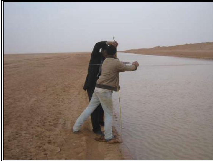
صورة (28): قياس هبوط منسوب مياه القرض الجديد الأول في بلطة الرملة الغربية بمقدار 145 سم خلال 120 يوم من تاريخ امتلاءه، بمعدل 1.208 سم/يوم، يوم وتاريخ القياس السبت 15.03.2014.
