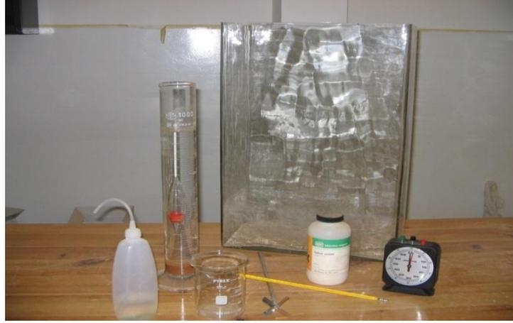
الشكل (3-1): معدات وأدوات تجربة التحليل الحبيبي للتربة الناعمة
