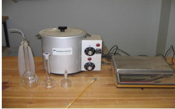
الشكل (5-1): معدات وأدوات تجربة الوزن النوعي
