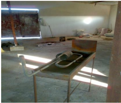
شكل 4. نظام التدفئة بالكيروسين في مساكن دجاج اللحم.
